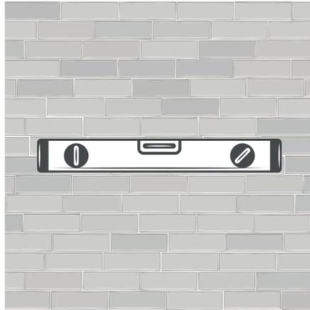
Verificare la planarità delle pareti e, in presenza di dislivelli, effettuare una rasatura preliminare.
