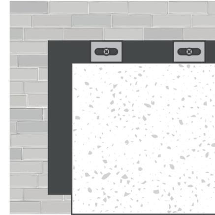
Fissare il pannello al supporto murario con tasselli a espansione e verificare l'allineamento orizzontale.
